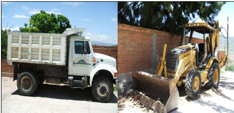
Imagen 17. Camión de volteo y retroexcavadora
