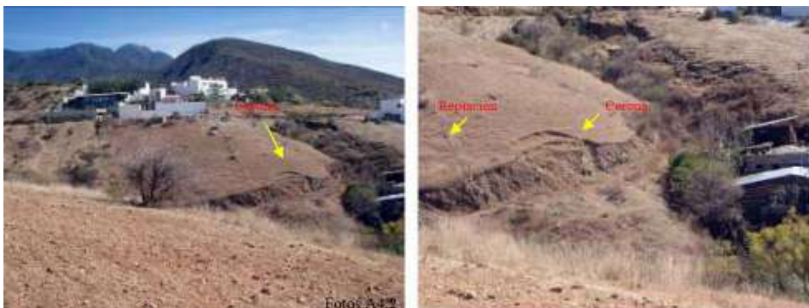
Figura 5.3.16. Estructuras de corona que indican proceso de reptación o deslizamientos lentos en la agencia San Felipe del Agua.
