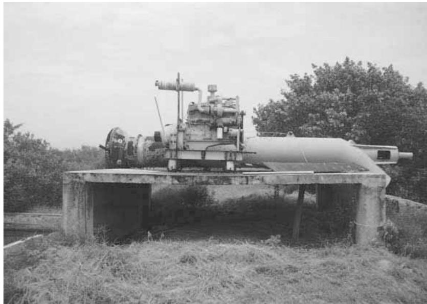
Figura 3.6 Equipo de bombeo en abandono por falta de mantenimiento y recursos económicos
