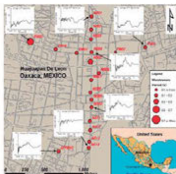
Gráfico 5 Ubicación de sensores para medir frecuencia de microsismos. Fuente: 8th International Workshop on Seismic Microzoning Risk Reduction, Almería, España, 15-18 Marzo 2009
