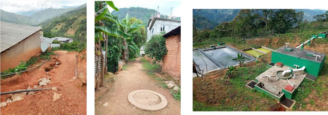
En San Felipe El Porvenir, la foto de la izquierda muestra las tuberías que conducen aguas negras hacia arroyos o terrenos, aunque existe una red de drenaje (foto central) pero no puede utilizarse por carecer de planta de tratamiento de aguas residuales. Foto derecha, la planta de tratamiento de la cabecera municipal está en funcionamiento.
