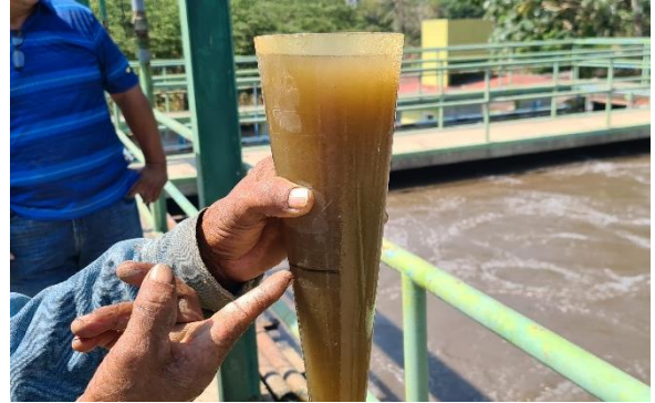
Fotografía 15. Sedimentación de agua residual
