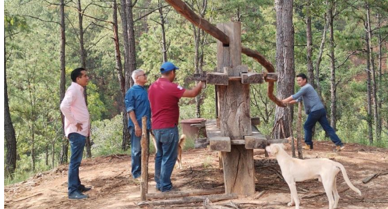
Foto 2. Trapiche artesanal para caña de azúcar que quiere rehabilitación y equipamiento
