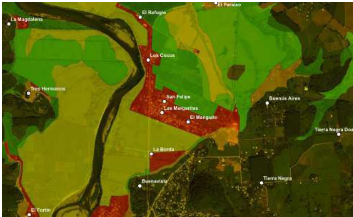
Figura 74. Donde se puede ver el riesgo por inundaciones a que están expuestas las localidades de Los Cocos, El Manguito, Las Margaritas y otras.
